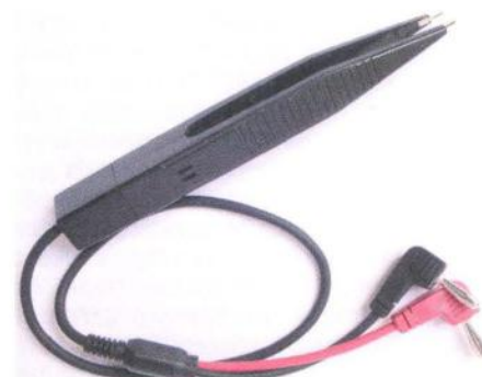
Obr. 13. Pinzeta na měření SMD součástek
