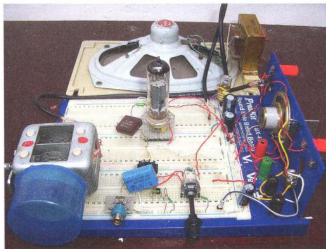
Obr. 3. Zesilovač s KFY18 a PL82 na zkušební desce
